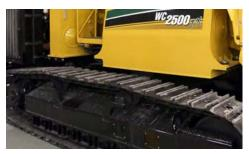
ESTEIRAS. Equipado com esteiras Berco D4 e sapatas simples ou duplas. Possui controle remoto que dá acesso em tempo real as informações de performance do equipamento e permite que toda a operação, o monitoramento e os ajustes sejam feitos de forma conveniente à distância..
