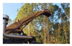
SISTEMA DE DESCARGA. Equipado com sistema forçado de descarga, garante máxima produtividade no campo ou no carregamento direto no caminhão. A calha possui sistema de peneiras que asseguram a qualidade do material.
