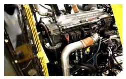
MAIOR EFICIÊNCIA. Modelo equipado com motor Cummins QSX15 de 600 hp (447,4 kW) de potência e embreagem PT Tech acionada hidraulicamente. Essa tecnologia requer baixo consumo de combustível, elimina a necessidade de ajustes manuais da embreagem, aumenta a vida útil e proporciona uma maior eficiência ao processo.
