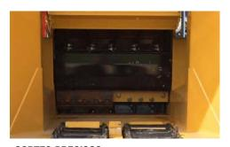
CORTES PRECISOS. Duas opções de rotor (2 a 4 cortes por revolução) permitem granulometrias variáveis entre 0,125" e 1,15".
