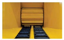
AUMENTANDO A PRODUTIVIDADE. Equipado com a tecnologia SmartCrush, utiliza automatização de regulagem de pressão de esmagamento do rolo, o que traz maior eficiência com materiais de grande porte. Conta também com correntes de alimentação dupla de velocidade variável, permitindo que o material seia puxado para dentro da máquina sem necessidade de empurre pelo operador.
