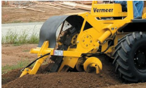
**VALETEAMENTO CONTÍNUO.** Em condições de terrenos mais duros, o sistema Autocreep da máquina entra em ação controlando automaticamente a velocidade do trator e o giro do implemento
