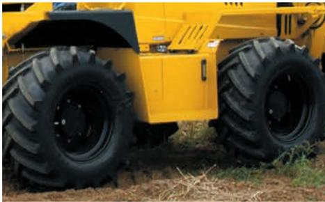
**MOBILIDADE.** A RTX1250 está disponível com pneus padrão de 97 cm que facilita a mobilidade em diferentes tipos de terrenos.
