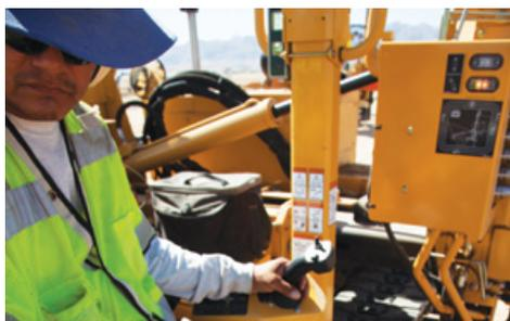
**ASSUMA O CONTROLE.** Dois controles no formato de joystick, permite ao operador controlar todas as funções da máquina sentado confortavelmente, incluindo o acionamento do martelo hidráulico, posicionamento da estaca e movimento do equipamento.
