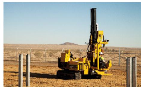
**TRAÇÃO EFICIENTE.** Mova de estaca para estaca rapidamente através de um sistema de tração robusto permitindo reduzir o tempo de instalação de cada estaca.
