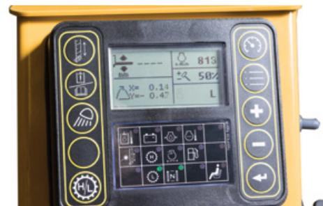
**NA PONTA DOS DEDOS.** O PD10 possui o já reconhecido sistema integrado de controle Vermeer, que oferece ao operador através do seu display uma variedade de informações sobre o equipamento em tempo real, incluindo ângulo de cravação, altura da estaca e dados de manutenção para ajudar com o agendamento das intervenções periódicas.
