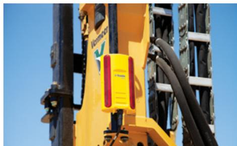
**MELHORE A SUA PRECISÃO.** Um receptor à laser integrado no sistema de controle está preparado para receber qualquer marca de GPS operando em 3 dimensões, que possibilita um aumento de produtividade.
