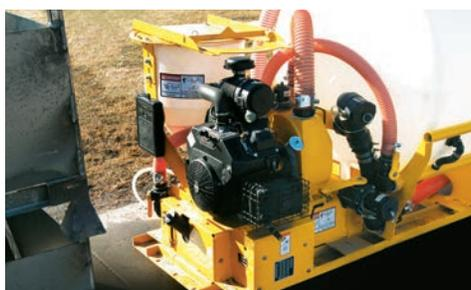
**DESENHO MODULAR.** O conjunto do motor e a bomba podem ser montados em ambos os lados do tanque, permitindo melhor acesso nas obras.
