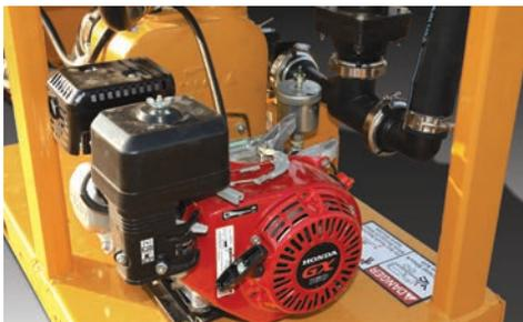
**OPÇÕES DE MOTORES.** O MX125 vem com opção de um motor Honda 5,5 hp a gasolina ou um Hatz 6,7 hp a diesel. Já o MX240 vem com opção de um motor Kohler CH732 de 23,4 hp a gasolina ou um Hatz 2G30 de 22 hp a diesel.
