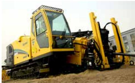
**MAIS FORÇA EM MENOS ESPAÇO.** O motor de 190 hp, 6 cilindros da D60x90s oferece 60.000 lb (264 kN) de empuxo e puxada, e 9.000 ft-lb (12.000 Nm) de torque rotacional em um equipamento com capacidade para várias aplicações, até nos espaços mais limitados.
