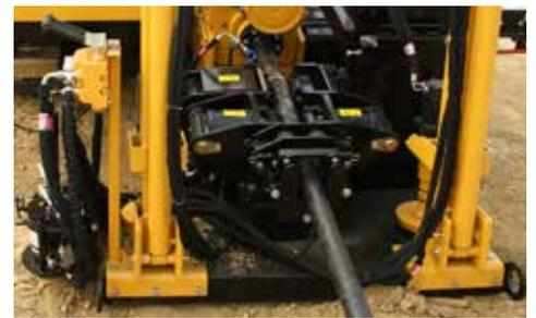
**SISTEMA DE MORSA COM ABERTURA SUPERIOR.** Permite a passagem de ferramentas maiores, além de dar visibilidade ao operador, para conectar e desconectar as hastes ou ferramentas.
