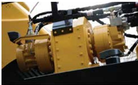
**CONFIGURAÇÕES DE VELOCIDADE DE ROTAÇÃO.** Combinando dois motores de alto torque, o operador possui três velocidades de rotação, aumentando a eficiência do trabalho.
