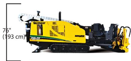
FÁCIL MANUTENÇÃO. Com o capô articulado feito em uma peça só, oferece maior durabilidade e fácil acesso aos pontos de manutenção. A D20x22II possui caixa de engrenagem unilateral e cremalheira sem solda.
