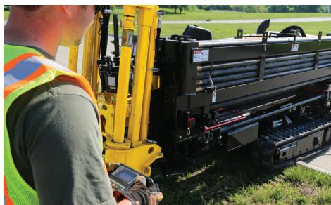
TRANSPORTE MAIS RÁPIDO E FORTE. A D20x22II é rápida e possui alta força de tração. Com o controle remoto sem fio, reduz o tempo de montagem da obra. As estacas dianteiras possuem motores hidráulicos que garantem maior segurança na operação.
