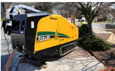
**COMPACTA E POTENTE.** Projetada com um design compacto e equipada com um motor de 4 cilindros Deutz com módulo ECU, a D23x30S3 oferece alta potência e flexibilidade, podendo trabalhar em locais de pouco espaço e em condições difíceis de solo.
