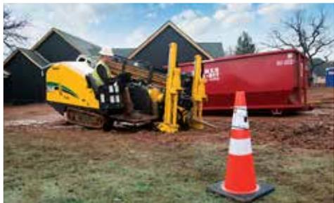
**MAXIMA PRODUTIVIDADE.** Com 24.000 lb (106,8 kN) de empuxo / puxada e 3.000 ft-lb (4.067,5 Nm) de torque rotacional, a D23x30S3 oferece um aumento de potência em relação a sua antecessora, a D20x22II - ajudando a maximizar a agilidade e eficiência. O equipamento conta com uma caixa de engrenagem localizada sobre pinhão de um lado e com cremalheira sem solda.
