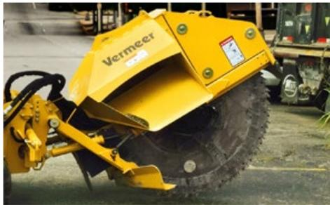
**RODA DE CORTE.** Em condições de terrenos mais duros, o sistema autocreep da máquina entra em ação controlando automaticamente a velocidade do trator e o giro da roda de corte. Essa sequência de comandos faz parte do sistema eletrônico chamado TrenchSense, ocorre dentro de poucos segundos e independente de ajustes do operador.
