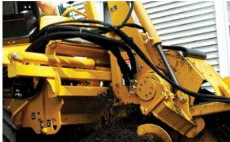
**SISTEMA OFFSET.** O sistema offset permite deslocar o implemento de valetamento lateralmente até o alinhamento dos pneus, auxiliando realizar o corte da vala mais próximo a uma parede ou sarjeta por exemplo.
