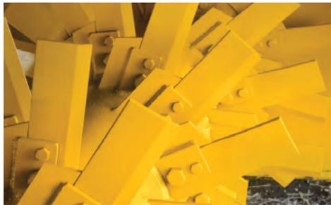
**PALETAS AGRESSIVAS.** As paletas e o tambor Vermeer proporcionam máxima aeração durante a operação. Quando aerada adequadamente, a pilha de composto se forma de maneira mais rápida e homogênea, com maior produtividade, chegando até 1.500 ton/h dependendo do material revolvido.
