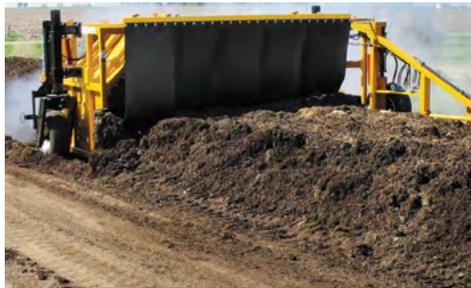
**CORTINAS DE CONTENÇÃO.** Cortinas de borracha na frente e atrás mantêm o material dentro da leira, reduzindo a quantidade e distância dos materiais arremessados, proporcionando maior segurança na operação.
