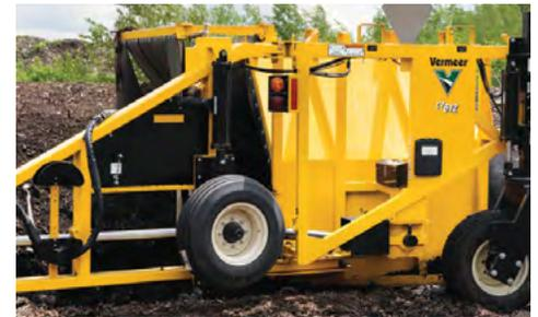
**ROBUSTEZ.** Construído a partir de 04 seções de aço estrutural tubular de 10,2 cm x 7,6 cm x 5 cm, adicionando rigidez e prolongando a vida útil do eixo e rolamentos do tambor.
